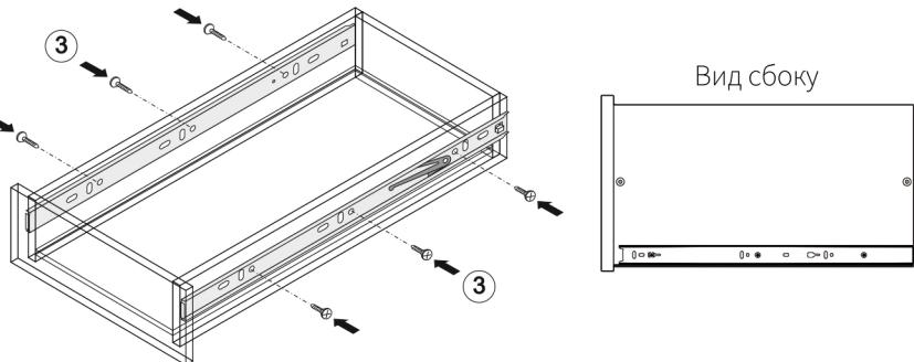
4. Прикрепите саморезами внешние неподвижные планки направляющих на боковые стенки корпуса в соответствии со схемой присадки.
