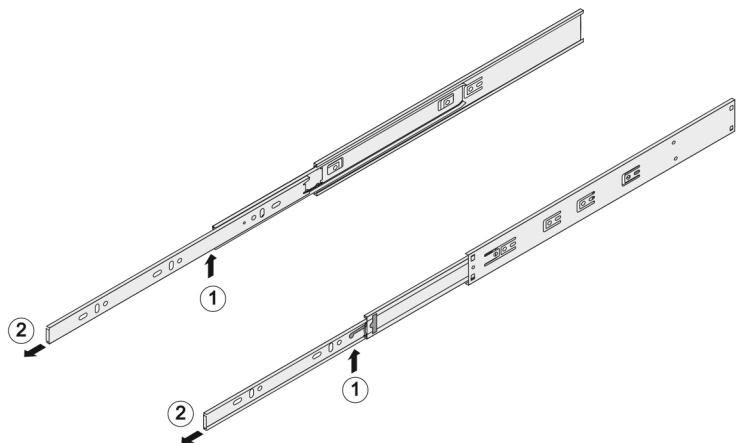
3. Закрепите саморезами внутренние подвижные планки направляющих к боковым стенкам ящика в самой нижней его части.
