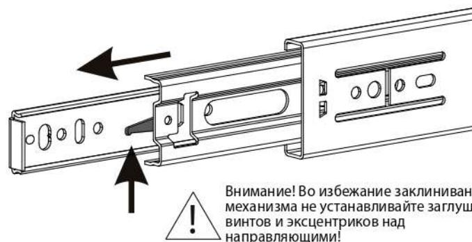
**Схема установки шариковых направляющих.**
